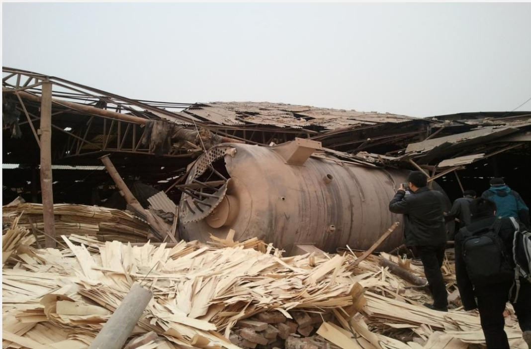
**事故原因：** 锅炉未安装安全阀，安全连锁装置未完成调试的情况下，使用单位擅自启用锅炉，违规操作，导致锅炉超压爆炸。
