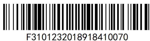
图 B.7 电梯部件编码一维码
