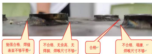
图 D2 焊缝外形合格与不合格的图示
