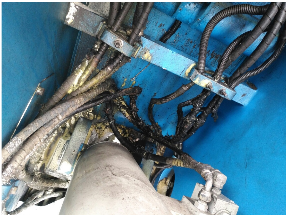
隐患排查中发现叉车的刹车油管有漏油现象
